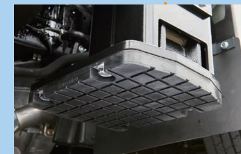
≫ゴム付きパッドベース ジャッキ張出時の路面傷付けリスクを低減
