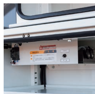
≫インバーター シャシーバッテリーやバッテリーユニットから100V電源の取出しが可能
