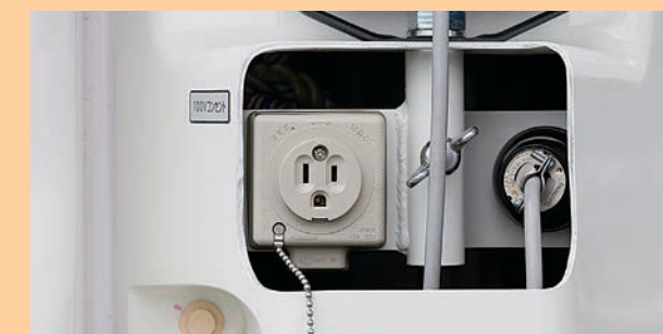
≫100V電源取出口 電源を接続することで、作業床で100Vの取出しが可能
