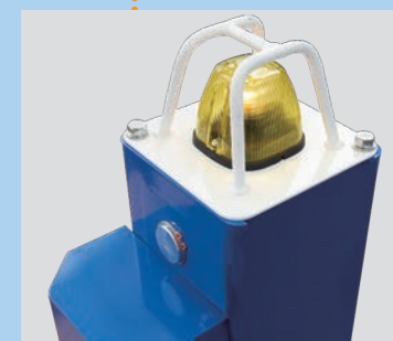
≫ジャッキ注意灯 PTO接続時に点灯し、周囲に注意喚起
