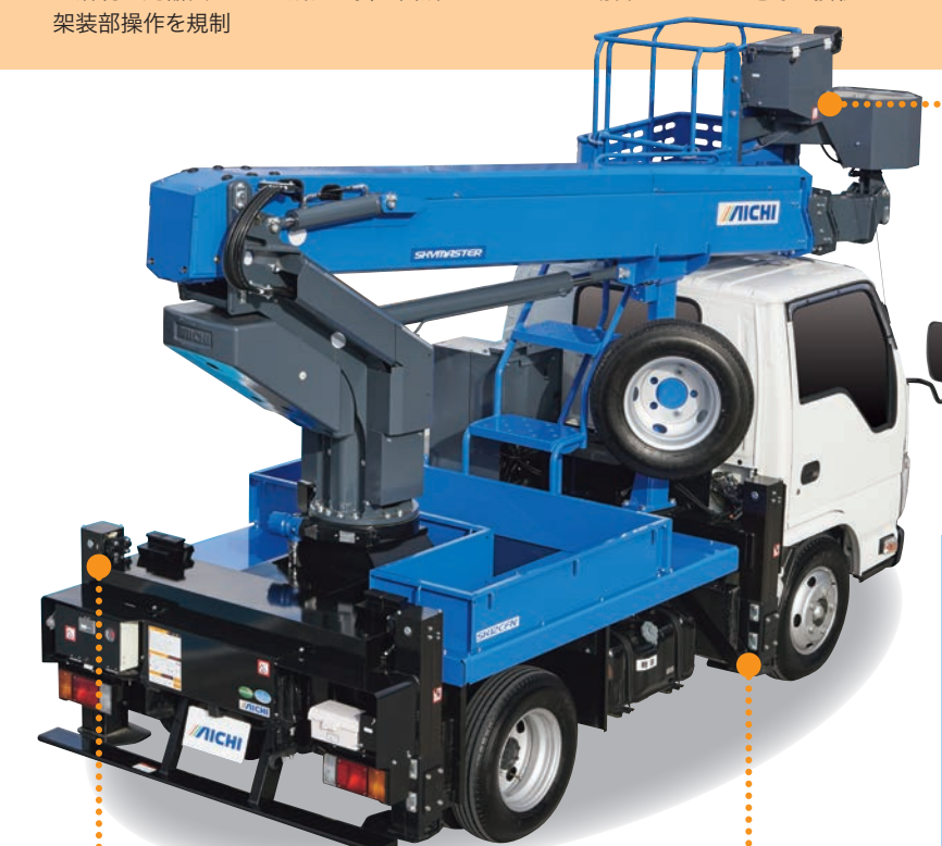
≫100V電源取出口 電源を接続することで、作業床で100Vの取出しが可能
