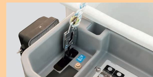
≫墜落制止用器具取付確認装置 墜落制止用器具フックを所定の掛け箇所にかけていない場合に 架装部操作を規制
