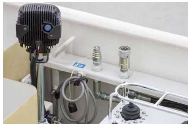
≫ 油圧取出口 03 作業床で油圧動力の取り出しが可能です。
