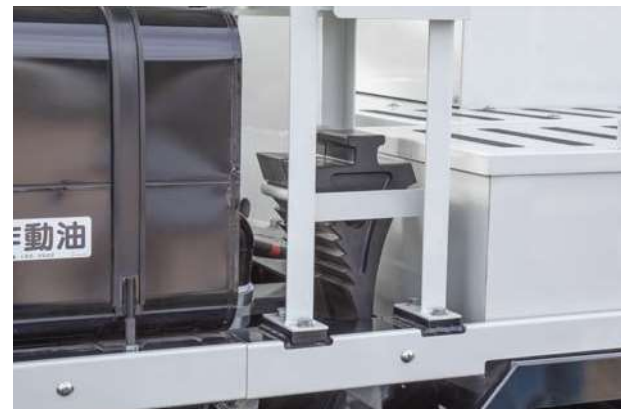
≫ 輪止め格納位置(助手席側) 05 使用場所の付近に格納場所を配置しました。
