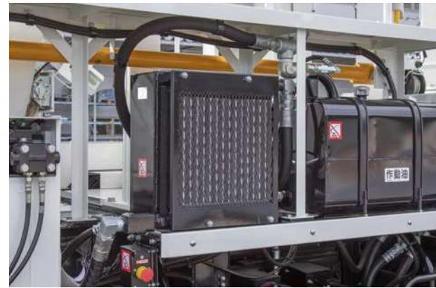
≫ オイルクーラー 02 高負荷連続作業によって温度上昇した作動油を冷却します。
