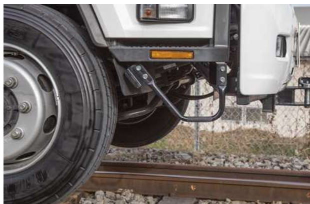
≫ キャビン乗降用ステップ 04 足掛けステップを使用することで、キャビンへの楽な乗り降りが可能です。
