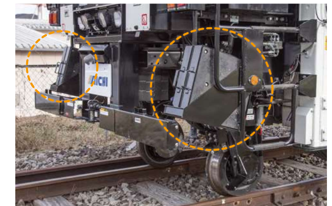
≫ ジャッキベース格納位置 09 使用場所の付近に格納場所を配置しました。
