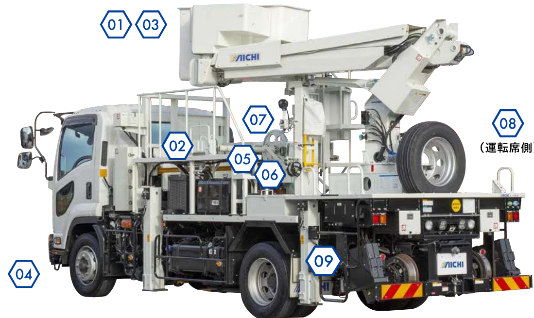
≫ 左工具箱 06 寸法(幅×高さ×奥行) 645mm×260mm×425mm
