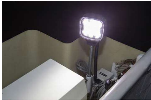
≫ 上部作業灯 01 操作者の視界を補助します。
