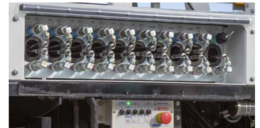
≫ 異常時油圧投入口 (アウトリガー、ジャッキ操作) 02
