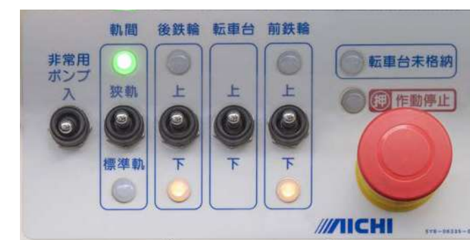
》鉄輪/転車台操作装置 06
