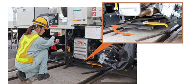
≫ 転車板格納アシスト装置 スイッチ操作で転車板の向きを調整可能です。
