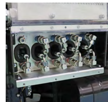
≫ 異常時油圧投入口 (アウトリガー、ジャッキ操作用)
