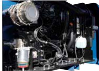
「オフロード法 排ガス4次規制」に適合した新エンジンの搭載で環境負荷を低減。さらに作業負荷に応じて最適なエンジン回転数を制御することにより、燃費を3%~7%改善します。(アイチ作業サイクル)
