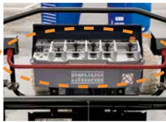
バー式セーフティスイッチを採用。バスケットの変形に強く、従来のワイヤー式と比較してより安心してお使いいただけます。
