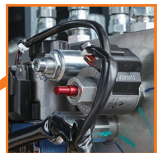
≫非常降下操作ボタン
