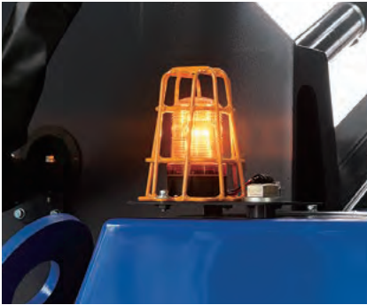
》黄色ストロボライト 電源を入ると点滅し 周囲に注意喚起を実施。
