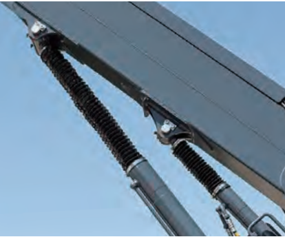
》シリンダーブーツ シリンダーロッドを保護し 異物侵入リスクを低減。
