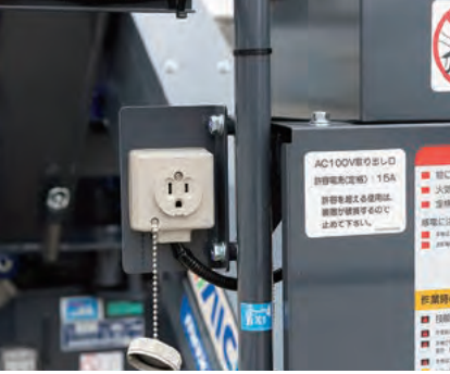
》上部100V電源取出口 電源を接続することで 作業床で100Vの取出しが可能。
