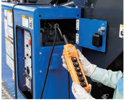
》走行リモコン 作業床へ搭乗せずに車両移動が可能。
